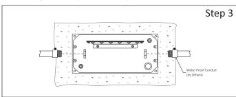
Step 3 - Install Electrical Conduit:
