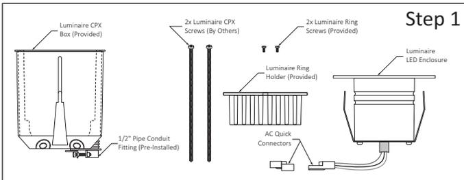
**Step 1 - Disassemble Luminaire Parts for easy Installation:**
