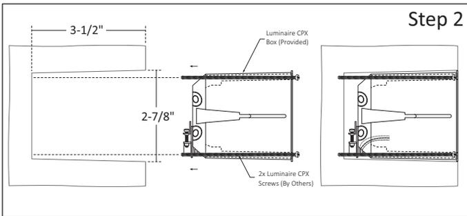
**Step 2 - Install Luminaire CPX Box:**
