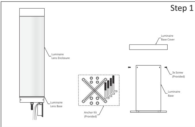
**Step 1 - Disassemble Luminaire Parts for easy Installation:**
