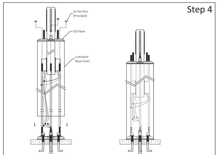
**Step 4 - Install Luminaire Base Cover:**
