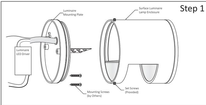
**Step 1 - Disassemble Luminaire Parts for easy Installation:**
